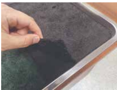
Поверхность сухого угольного шлама, обработанная более 13 месяцев назад профилактическим средством «Антипыль» марки П (пленкообразующий). Образованная корка толщиной 5-10 мм сохраняет эластичность
